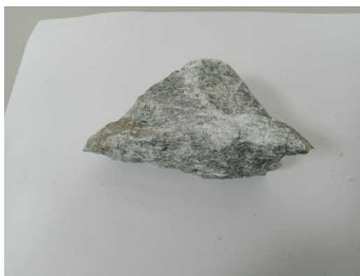
圖 63：敲擊產生的斷面側面
