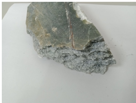
圖 65：由裂紋敲擊產生的斷面
