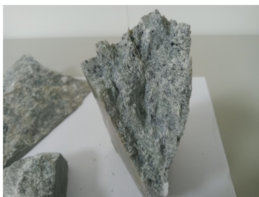
圖 64：由裂紋敲擊產生的斷面
