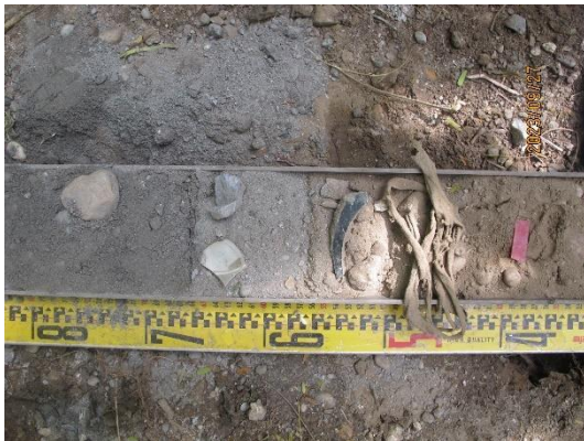
圖 60：6 號鑽探點底部仍有回填垃圾
