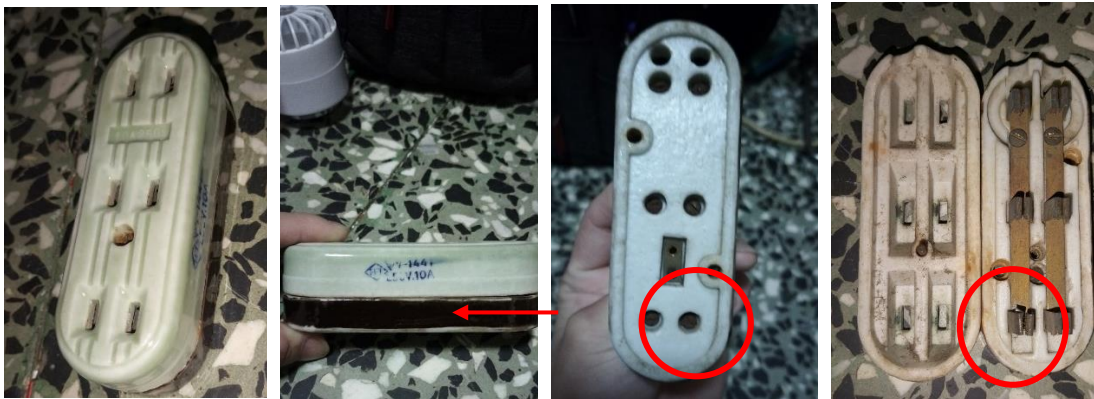
圖 53：陶瓷插座（箭頭、紅圈處為殘件部位） 19
