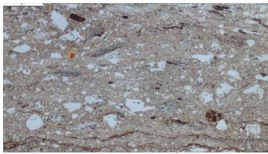
圖版 20：樣本 LPS10 以變質岩類為主，偶見沉積岩類(平行偏光下)。
